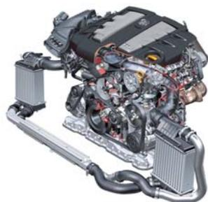
En 2003, Audi a mis en place le premier moteur V6 TDI avec une cylindrée de 3,0 l, une rampe d'injection commune et une chaîne d'entraînement. Ce moteur a ensuite été utilisé en série chez Volkswagen en 2005.
